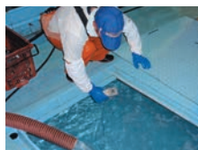
① 出港前、船倉に殺菌冷海水を積み込みます。
