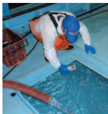
①出港前、船倉に殺菌冷海水を積み込みます。
